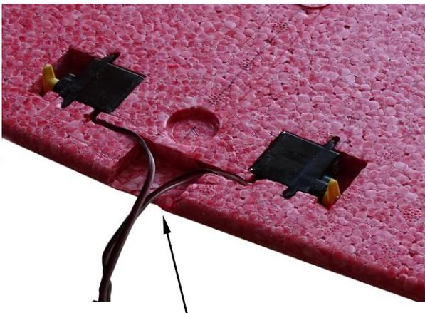
Diese Freimachung dient zum Verstauen der Kabel, wenn der Flügel in den Rumpf geschoben wird.
